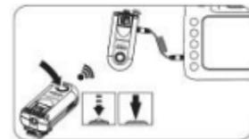
4.Нажмите многофункциональную кнопку трансивера наполовину, фотокамера начнет фокусировку. Нажмите кнопку полностью, когда индикатор фокусировки горит зеленым, фотокамера делает снимки, индикатор спуска загорится красным.
